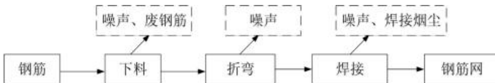
图 2-2 钢筋网加工工艺及产污环节图（G 废气、S 固体废物、N 噪声）
